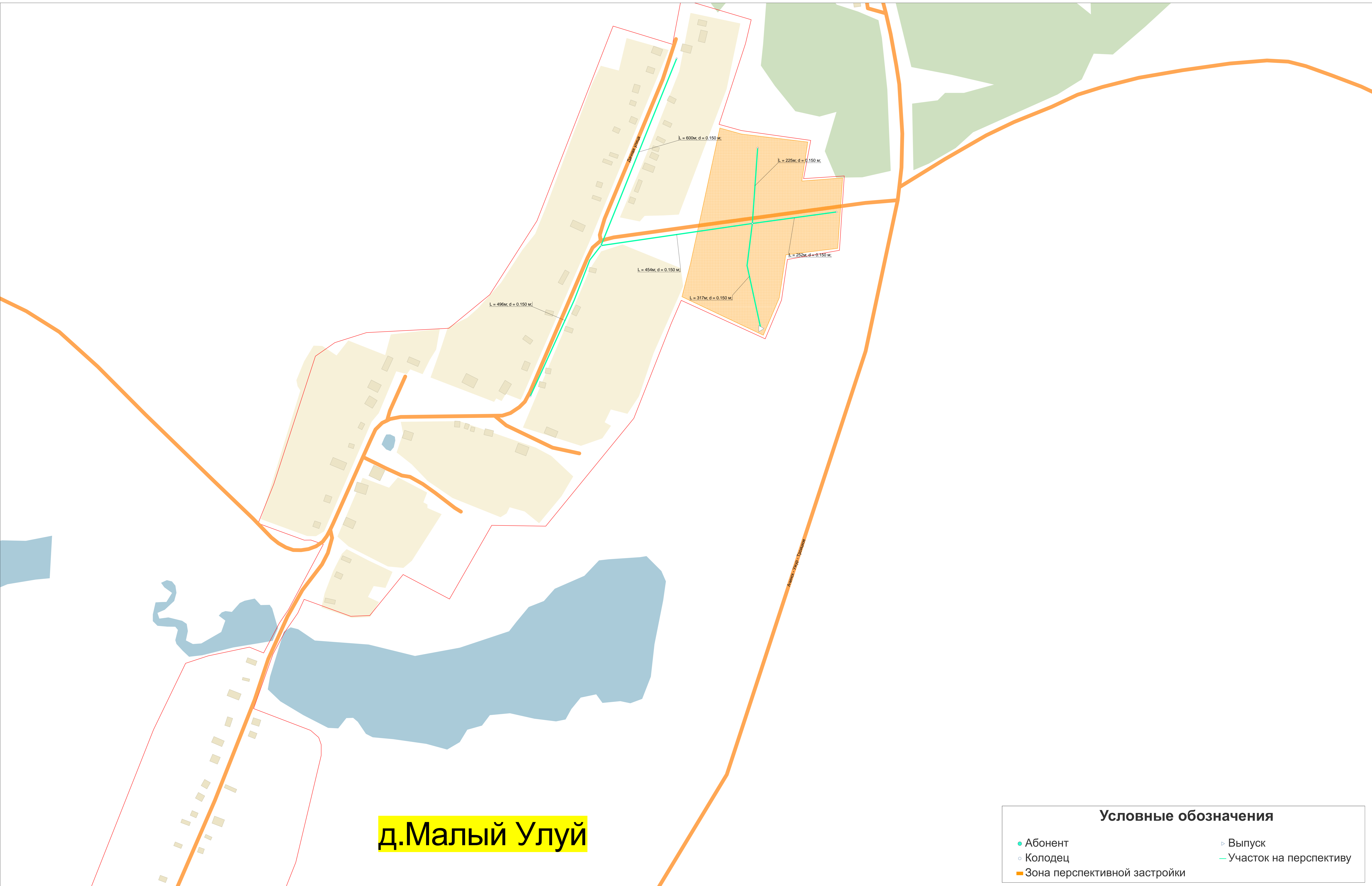
Рис. 7. Перспективная схема водоотведения д.Малый Улуй
